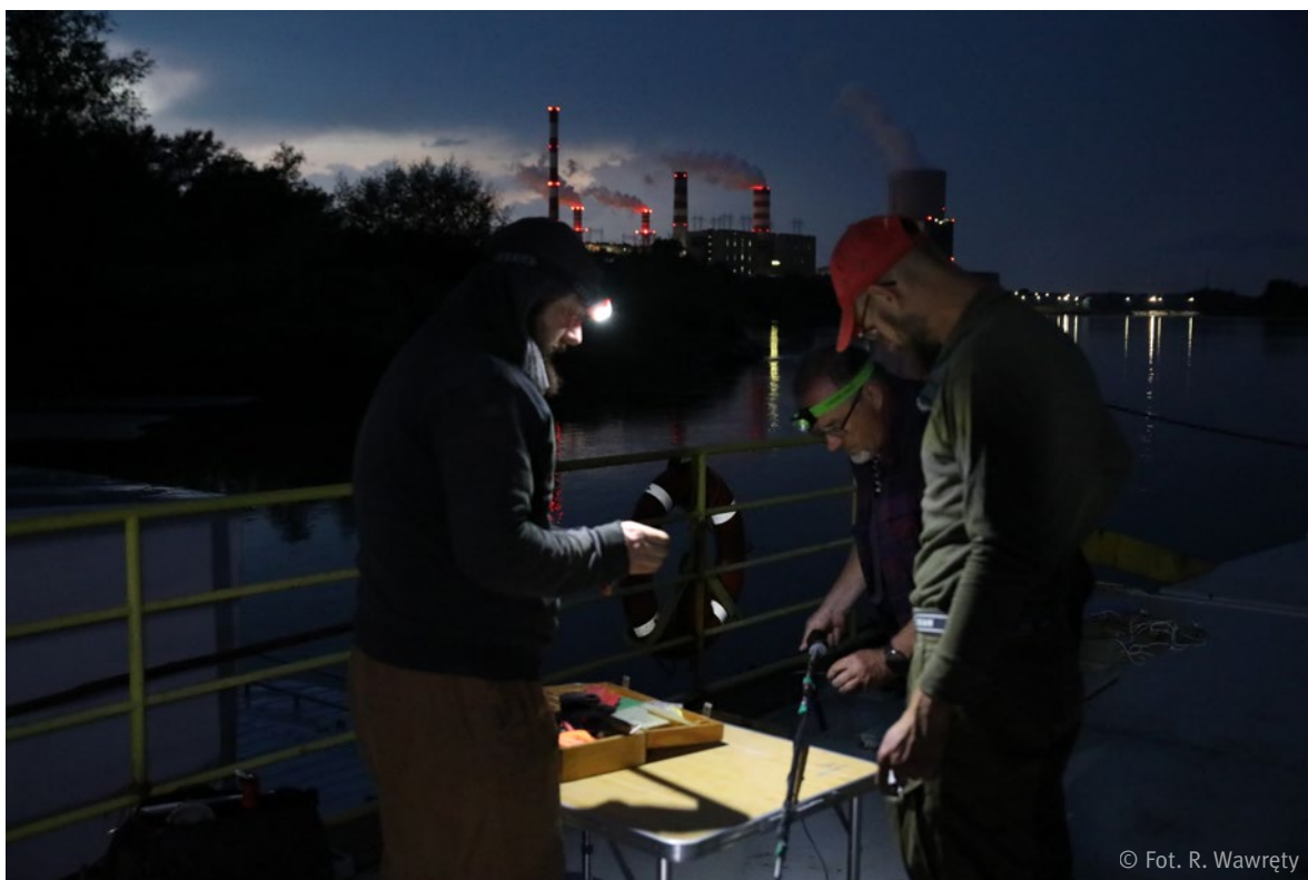
Fot. 3. Przygotowanie młynka hydrometrycznego do pomiaru prędkości wód Wisły w czasie trwania poboru prób dryfu.
