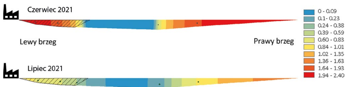
Ryc. 11. Wizualizacja koncentracji ichtioplanktonu (osobniki/m³) wg skali (panel po prawej) na przekroju Narwi przed elektrownią w Ostrołęce w oparciu o odłowy na całej szerokości rzeki. Panel górny - czerwiec 2021 r., panel dolny - lipiec 2021 r. Obszar zakreskowany reprezentuje część Narwi (%) zabieraną w danym okresie przez elektrownię, odpowiednio 20,9% w czerwcu i 19% w lipcu. Wyliczone zagęszczenie ryb w pobranej wodzie interpolowane za pomocą Radialnej Funkcji Bazowej wynoszą 1,175 i 0,122 osobników na metr sześcienny odpowiednio w czerwcu i lipcu. Średnie zagęszczenie larw/m³ na całym przekroju Narwi wynosiło 0,771 w czerwcu i 0,132 w lipcu.
