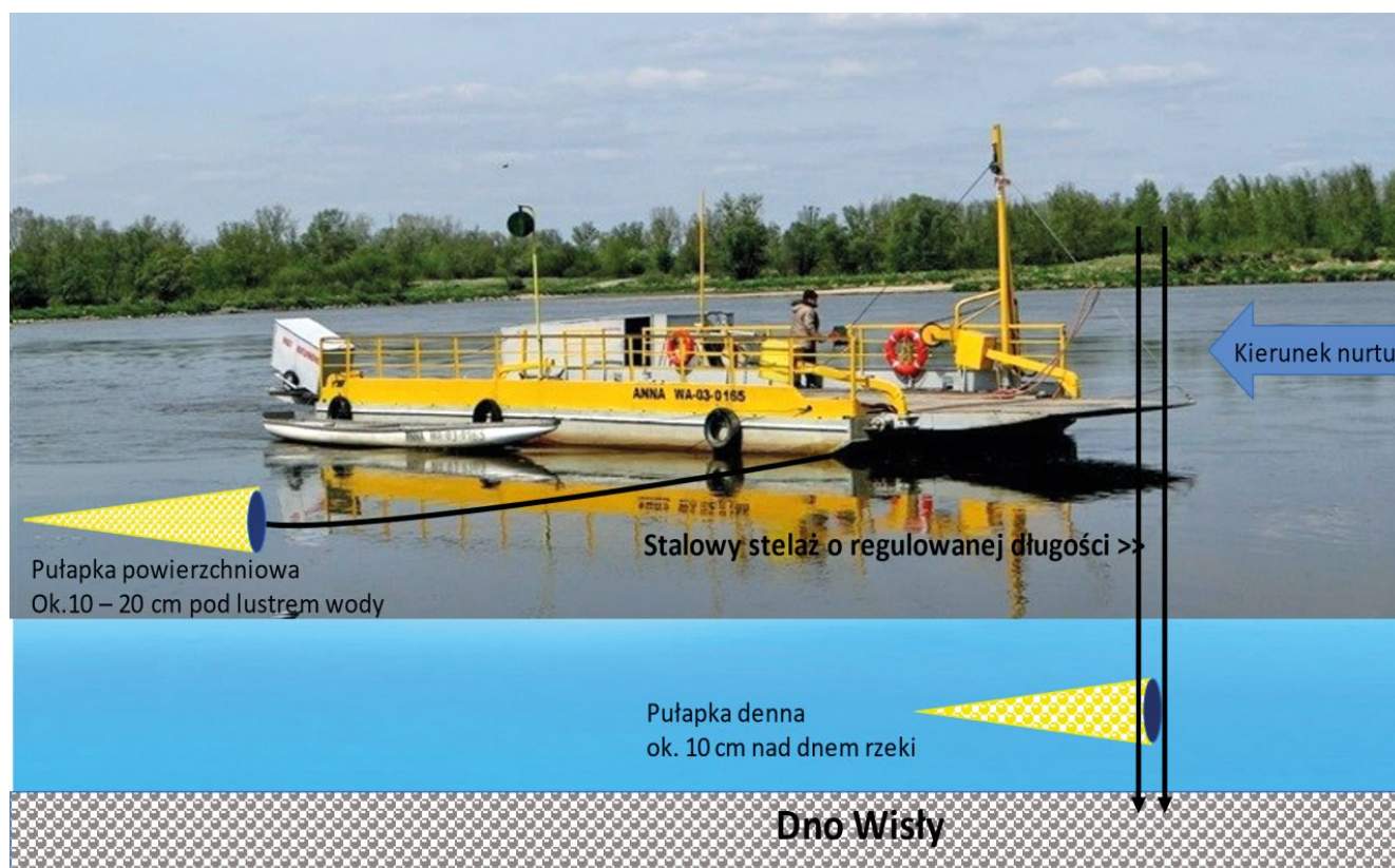
Ryc. 2. Prom w Świerżach Górnych. Schematyczna wizualizacja sposobu pobierania prób dryfu ichtioplanktonu na całej szerokości Wisły z pokładu promu. Stalowy stelaż z pułapką denną był mocowany do burty promu od strony górnej wody. Pułapka powierzchniowa dryfowała na kilkumetrowej linii za promem. Na podstawie: https://cutt.ly/HHpMRlx .
