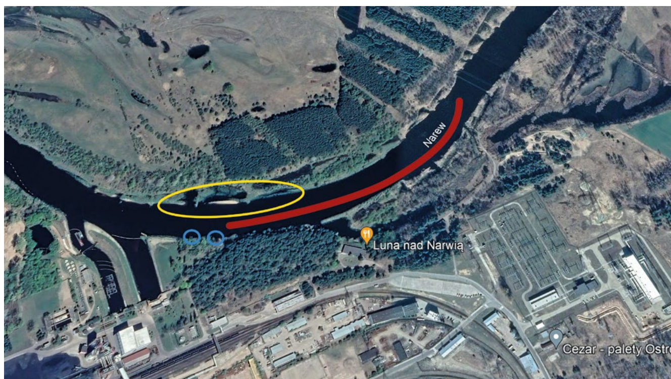
Ryc. 4. Lokalizacja punktów monitoringowych ichtiofauny w rejonie Elektrowni Ostrołęka B. Niebieskie kółka przedstawiają miejsce posadowienia pułapek na dryfujące larwy ryb i narybek. Szeroka czerwona linia przedstawia trasę spływu łodzi i elektropołowów. Żółta elipsa wskazuje rejon odłowów sieciowych (włokiem). Połowy dryfu na całej szerokości Narwi przeprowadzono na wysokości pułapek stacjonarnych (czerwona linia). Źródło: Google Earth Pro.
